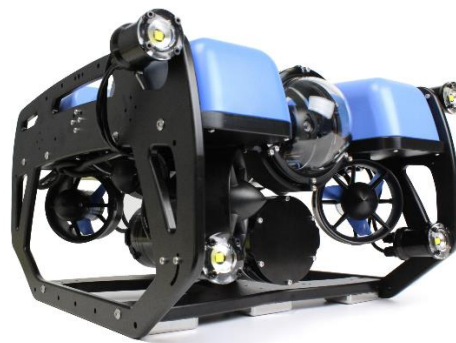
Figura 7 – BlueROV2 da BlueRobotics em configuração padrão
