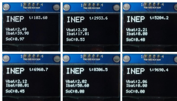
Figura 4.43 – Pontos capturados no display Oled na estimativa em tempo real do SoC pelo EKF.
