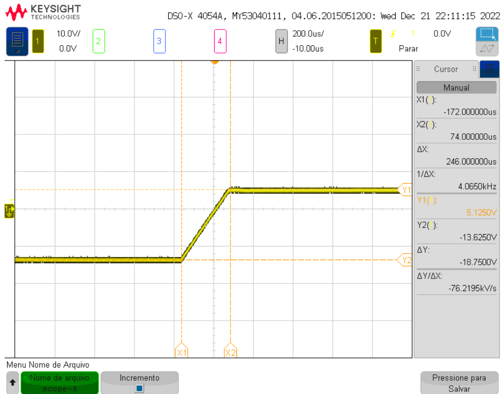
Figura 4.5 – Tensão V_{GS} MOSFET módulo 1 com corrente de 9,95 A.
