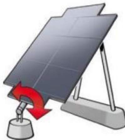
Figura 13 - Sistema de rastreamento de eixo único, vertical.
