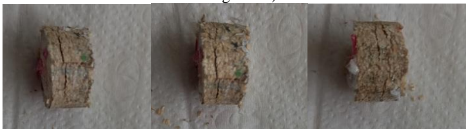
Figura 20: Amostras de CDR compactado que apresentaram trincas C3 (pinus com adição de glicerol)
