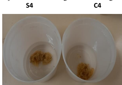
Figura 18: Decomposição dos CDR mergulhados em água para teste de umidade
