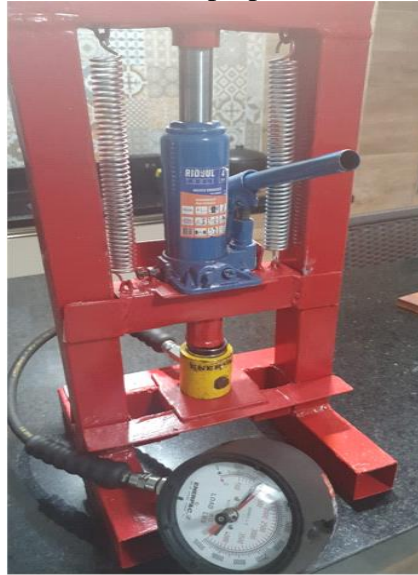
Figura 13: Prensa hidráulica utilizada no preparo das amostras de CDR compactado
