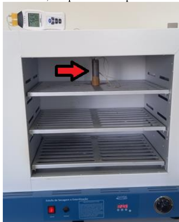
Figura 14: Amostra na estufa, compartimento da prensa e controle de temperatura
