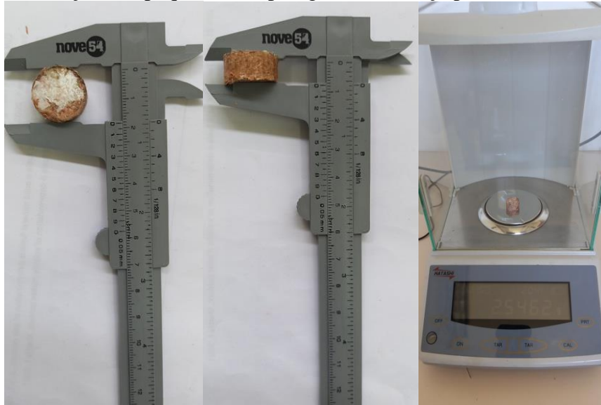
Figura 17: Medições no paquímetro e pesagem na balança para cálculo de densidade
