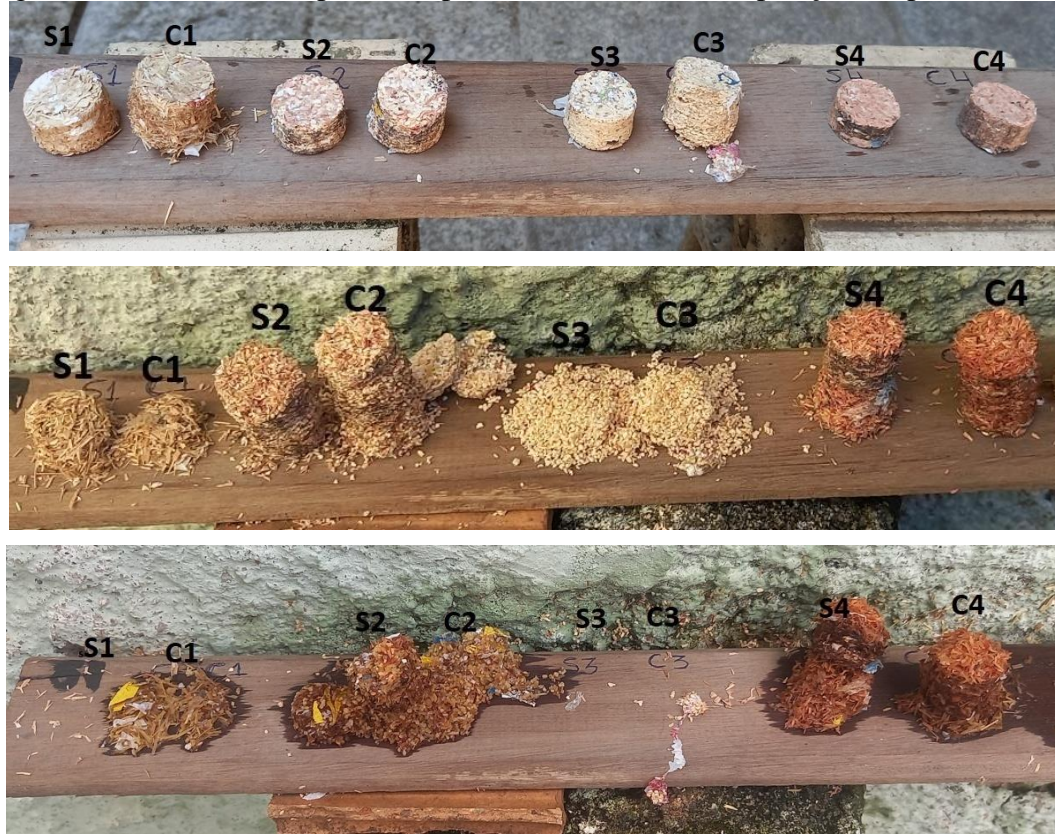
Figura 22: Teste de intemperismo após 5, 10 e 14 dias de exposição, respectivamente
