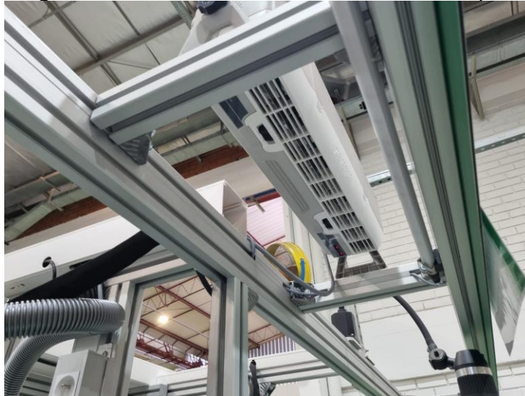
Figura 18 – Ar-condicionado instalado na máquina
