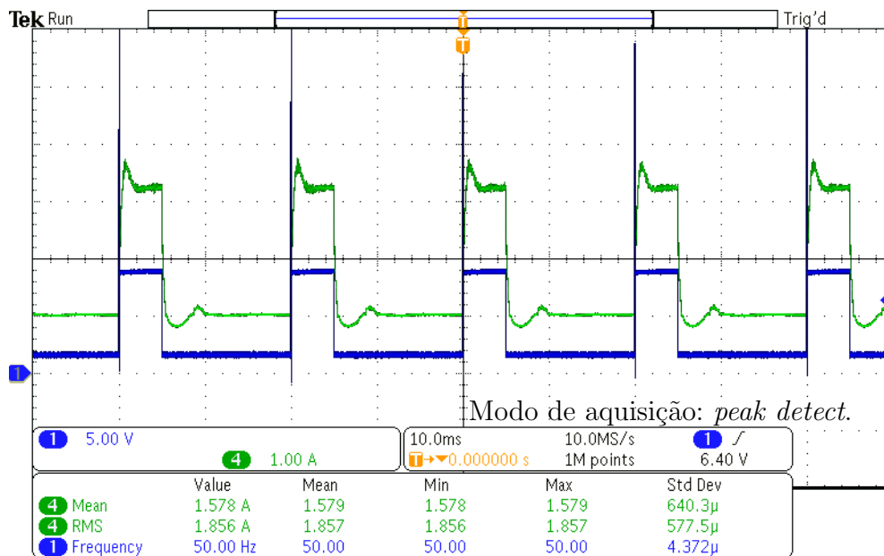
Figura 102 – Corrente de entrada da fonte (Canal 4). I_O = 5 A. Chave moduladora comutando a 50 Hz. Tensão nos terminais de saída da fonte (Canal 1).
