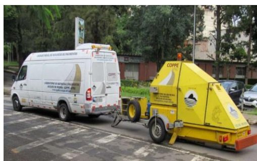
(a) Equipamento FWD em campo
