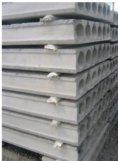
Figura 4 – Armazenamento de lajes alveolares pré-fabricadas.
