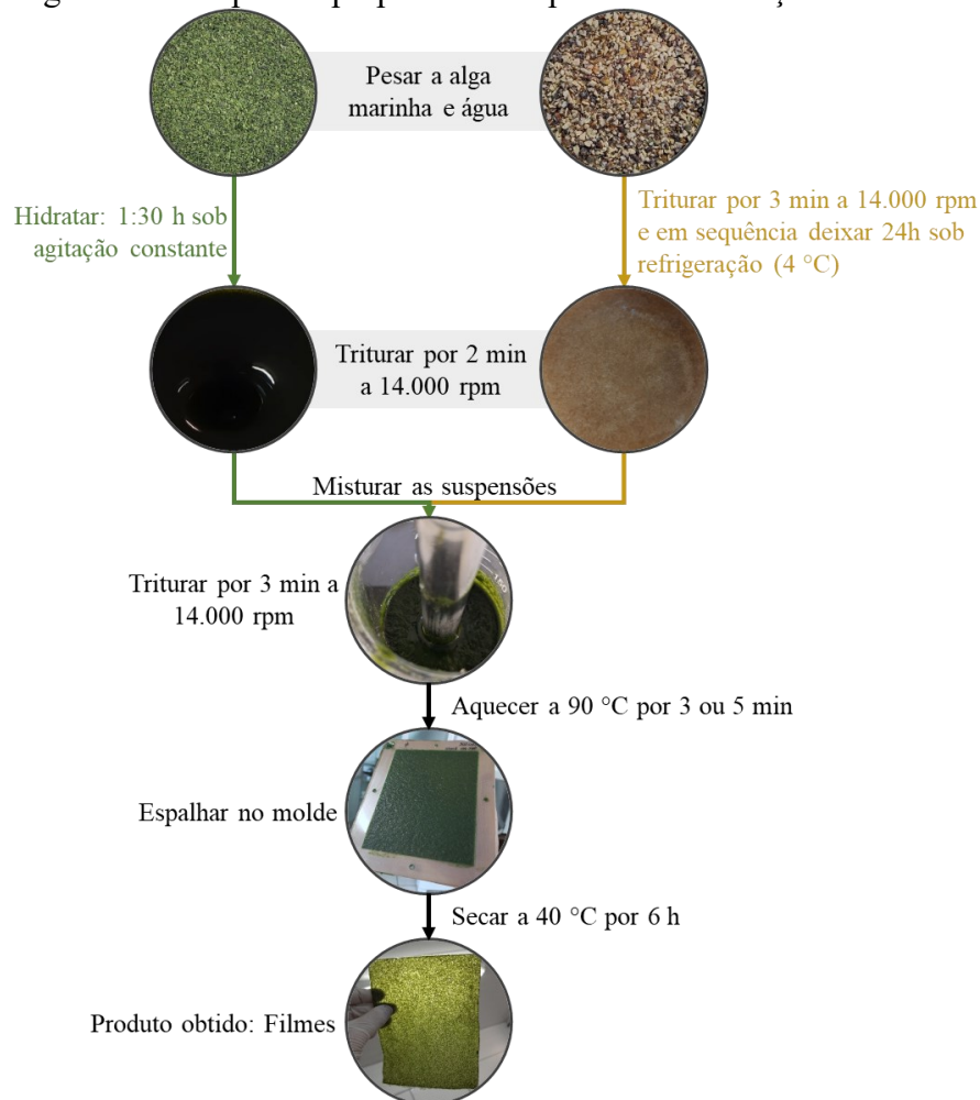
Figura 12 – Etapas do preparo das suspensões e obtenção dos filmes
