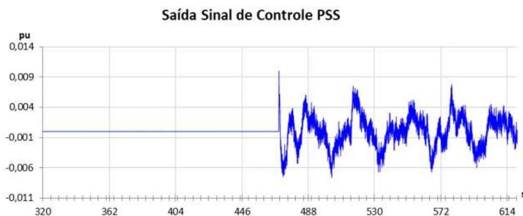
Figura 19 – Sinal de controle gerado pelo PSS.
