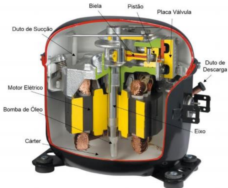
Figura 1 Corte de um compressor hermético a pistão.
