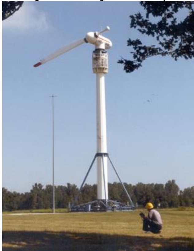
Figura 2.11 - Aerogerador de uma pá
