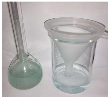
Figura 4. A esquerda, filtração da solução-amostra de fertilizante ( 5.3.1 c ).
