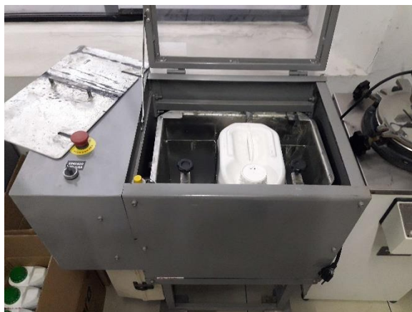
Figura 2. Agitador personalizado semelhante ao tipo Wagner.
