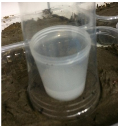
Figura 2 - Respirometria do sedimento, após adição do biorremediador nas concentrações de 150g por hectare e 300g por hectare, a cada três dias. Recipiente contendo hidróxido de sódio. Fonte: Arquivo pessoal
