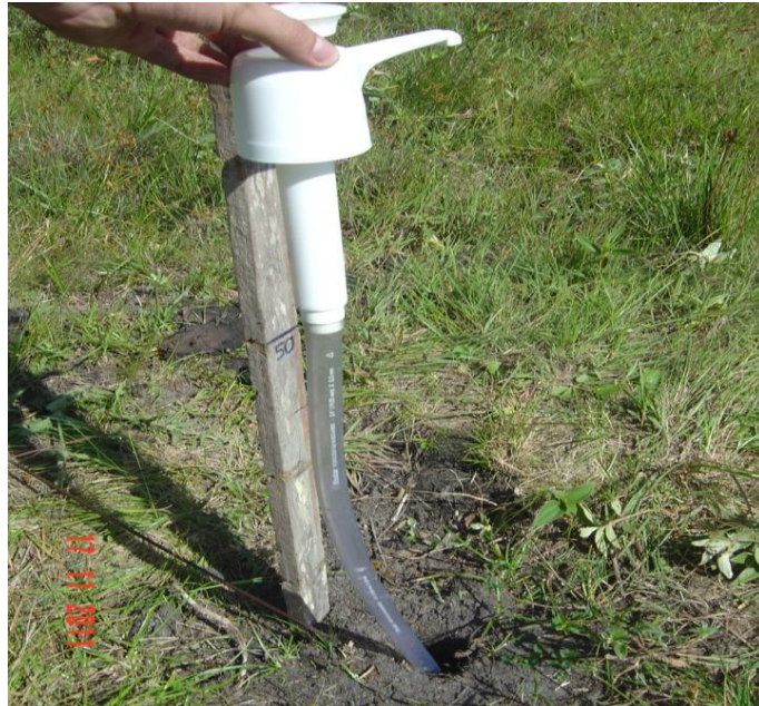
Figura 9. Bomba para rebaixamento do nível freático (Foto: Raphael Niero, 2011)
