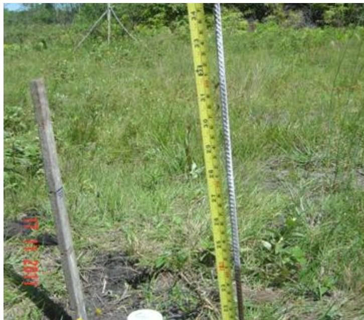
Figura 7. Leitura do nível estático do lençol freático. (Foto: Raphael Niero, 2011)
