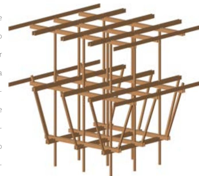
Estrutura em madeira e modular de 2x2m
