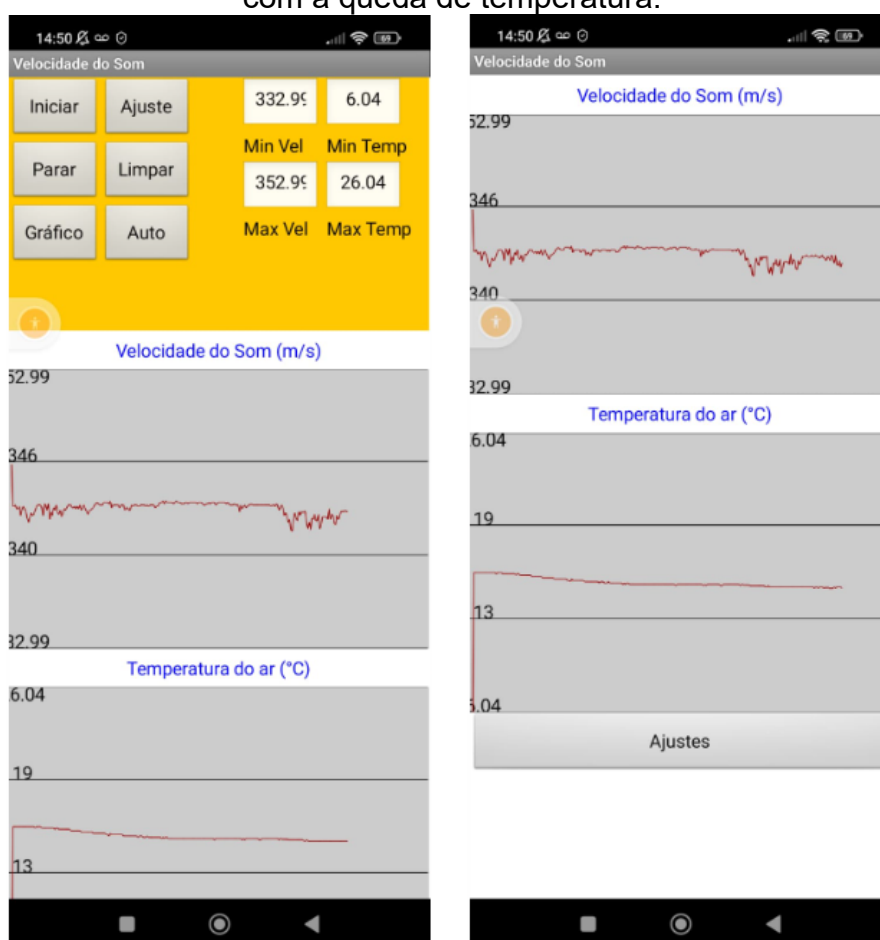
Figura 7 e 8 – Gráfico do Teste em Ambiente Resfriado, a velocidade diminuiu com a queda de temperatura.
