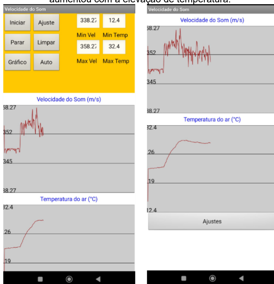
Figura 9 e 10 - Gráfico do Teste em Ambiente Aquecido, a velocidade aumentou com a elevação de temperatura.
