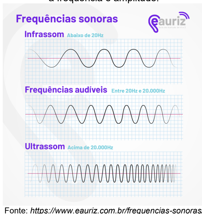
Figura 2 – Comparação do comportamento das ondas sonoras de acordo com a frequência e amplitude.
