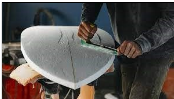
Figura 7 - Uso do surform no processo de produção da prancha
