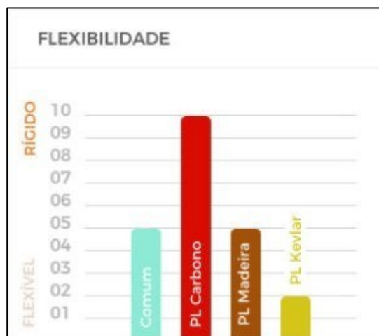
Figura 15 - Percentual comparativo de flexibilidade entre Powerlight x pranchas comuns
