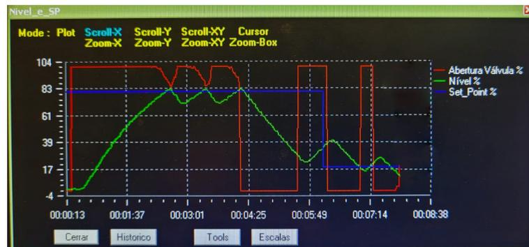
Figura 27 – Comportamento do controle do sistema.
