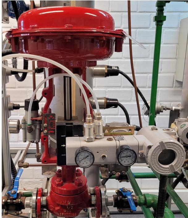
Figura 18 – Posicionador FY302 utilizado.
