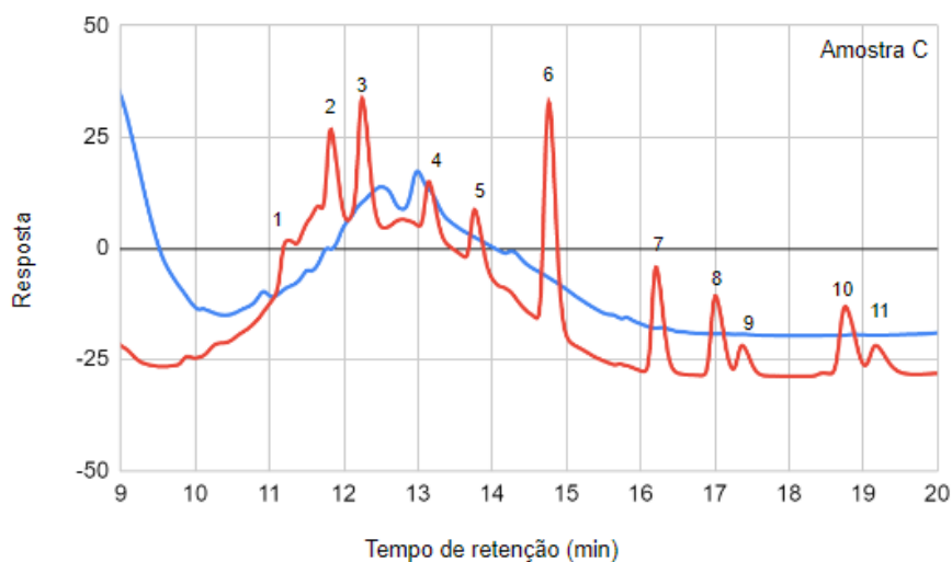
Figura 29. Cromatogramas em 254 nm dos extratos da amostra C sem fortificação (azul) e fortificada em 150 \mu\text{g L}^{-1} (vermelha). Sendo: 1) FLU, 2) PHEN, 3) ANT, 4) FLT, 5) PYR, 6) CRY + BaA, 7) BbF, 8) BaP, 9) DBahA, 10) BghiP e 11) IP.
