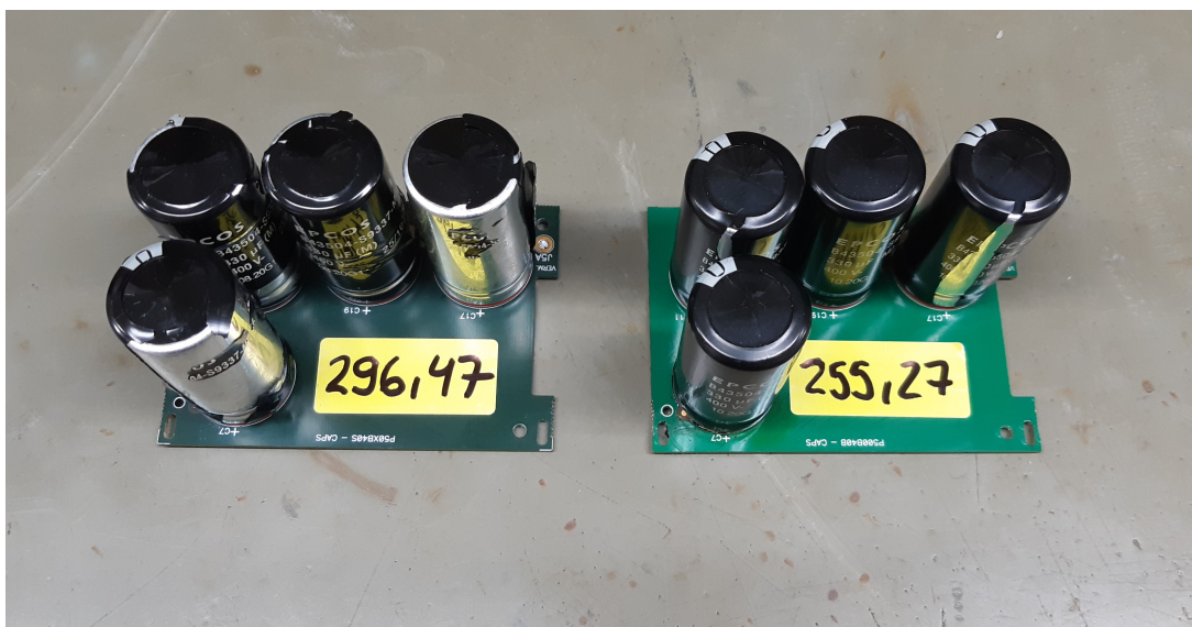
Figura 40 – Banco capacitivo de amostras degradadas de 296,47 \mu\text{F} e 255,27 \mu\text{F} .
