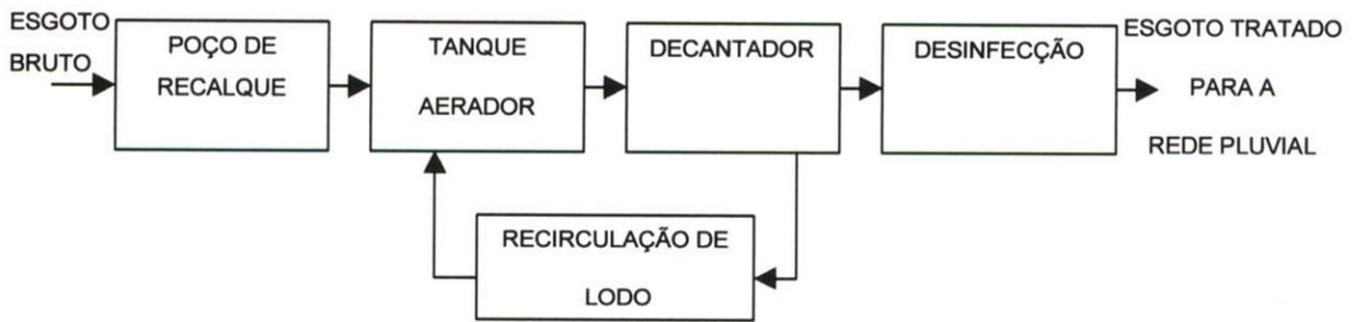
Figura 7: Fluxograma de funcionamento do processo Contínuo
