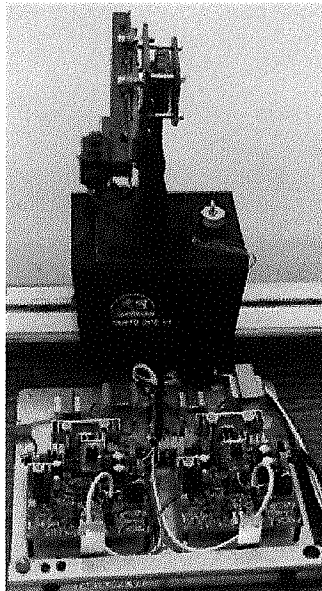
Ilustração 6-3: Sistema mecânico e acionamento da versão II
