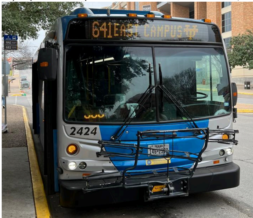
Figura 89 - Suporte para bicicletas na parte frontal do ônibus na Universidade do Texas (Estados Unidos)
