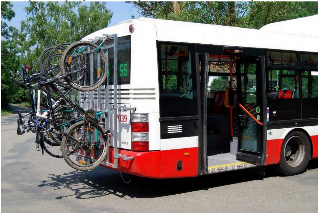
Figura 90 - Suporte para bicicletas na parte traseira de ônibus em Brno (República Tcheca)
