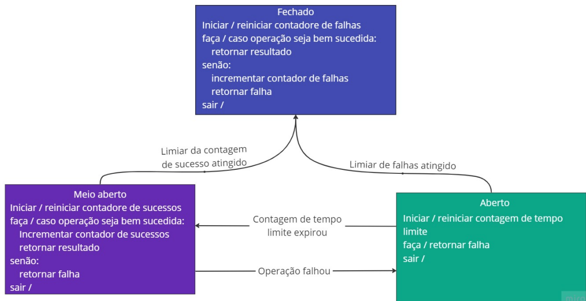
Figura 6 – Algoritmo e máquina de estados do disjuntor
