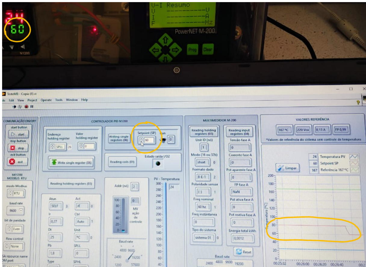
Figura 43 – Alteração do setpoint do controlador PID
