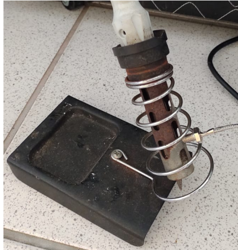
Figura 38 – Suporte do ferro de solda com o termopar fixo
