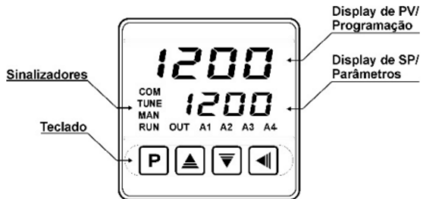
Figura 25 – Display principal do controlador PID N1200
