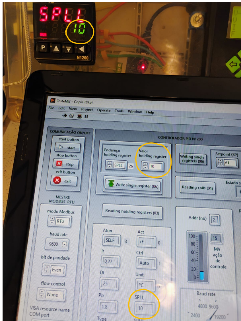
Figura 42 – Escrita e leitura do parâmetro SPLL do controlador PID
