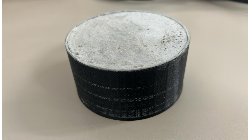
Figura 6 – Recipiente com a argamassa
