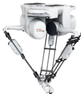
Figura 6 - Robô do tipo Delta modelo FANUC M-3iA/6A
