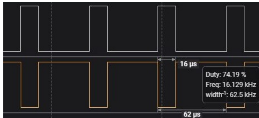
Figura 23 – Detalhe do PWM complementar.
