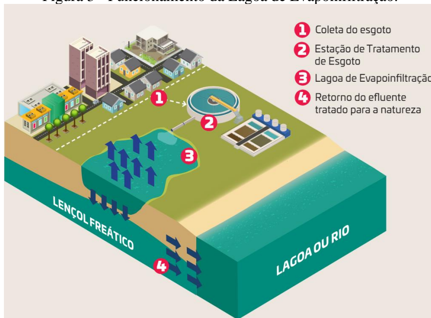
Figura 3 - Funcionamento da Lagoa de Evapoinfiltração.
