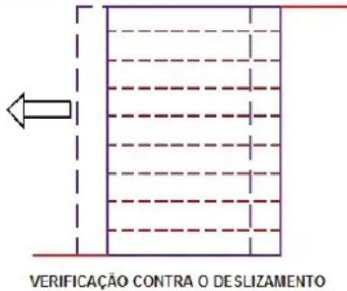
Figura 31: Verificação contra o deslizamento.
