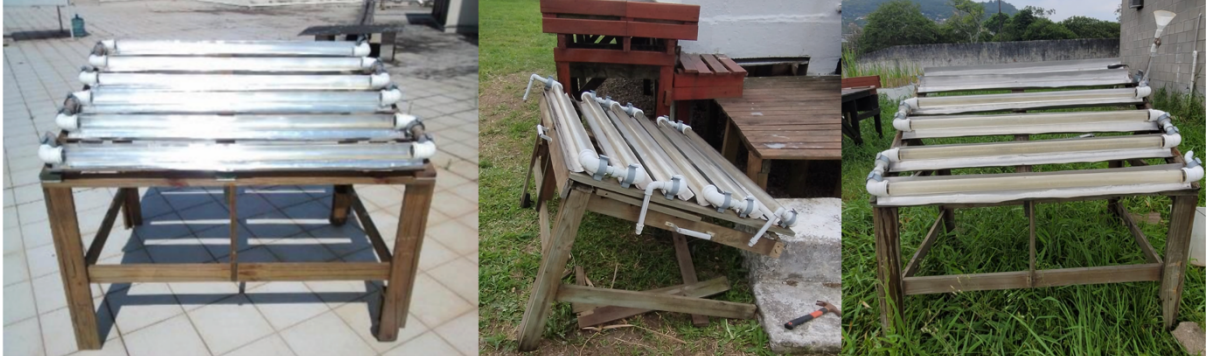
Figura 8– Reator CPC originalmente (esquerda), durante o processo de reconstrução (centro) e atualmente (direita)
