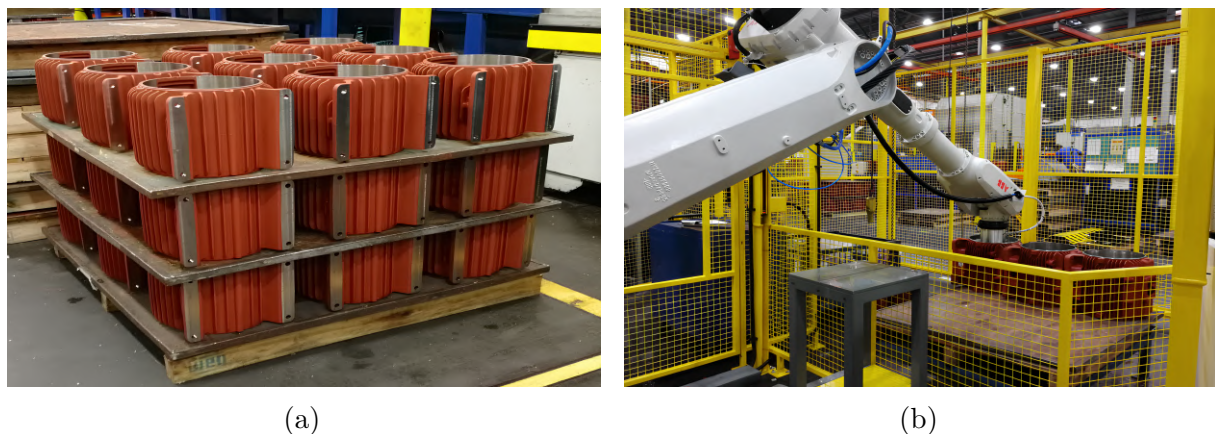
Figura 2 – (a) Palete produzido (b) Soltura da peça na paletização (PEGORETTI, 2021).
