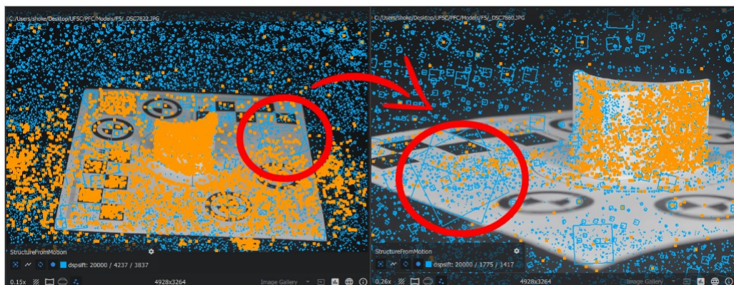
Figura 23 – Extração e correspondência de características (conjunto de seta e círculos vermelhos). Duas imagens de perspectivas diferentes.
