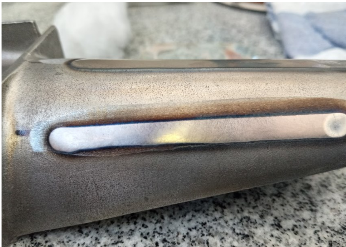
Figura 57: Aspecto visual da palheta soldada na condição inicial como fornecida.
