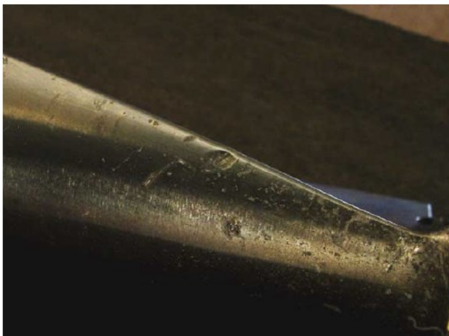
Figura 7: Erosão em uma pá de turbina (CARTER, 2005).
