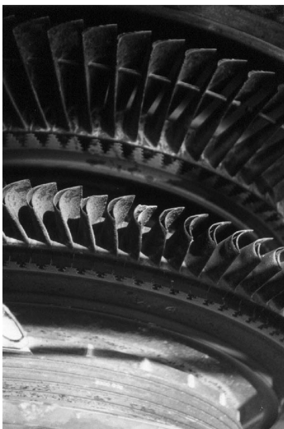
Figura 5: Pás do primeiro e segundo estágios de uma turbina (GIAMPAOLO, 2006).
