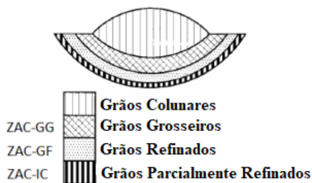
Figura 32: Regiões da ZAC em solda de aço baixo carbono de passe único (Adaptado de KOU, 2003).
