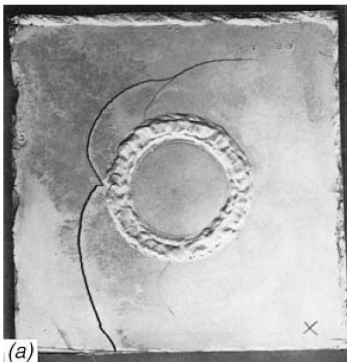
Figura 31: Propagação de trinca na superliga de níquel Rene 41 (PRAGER; SHIRA, 1968).
