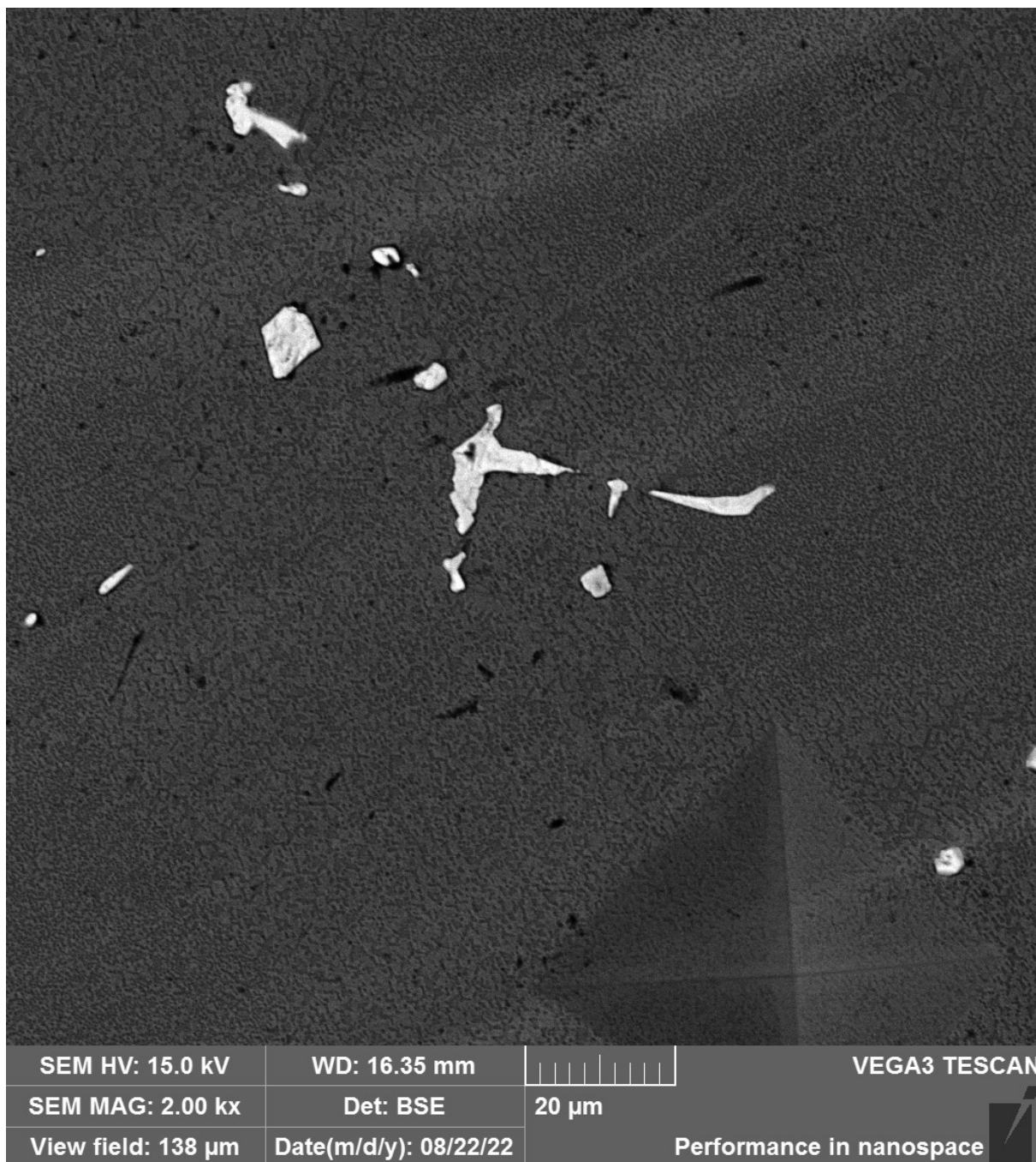
Figura B - 43: Imagem de MEV, material soldado com aporte térmico de 2,1 kJ/cm no estado solubilizado e submetido a TTPS de precipitação.
