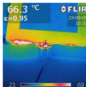
b) Devido ao efeito de reflexão do alumínio, a imagem termográfica não conseguia ser capturada.
