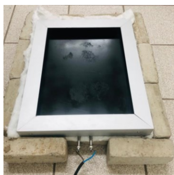
e) Dispositivo experimental coberto com tinta preta especial de alta temperatura
