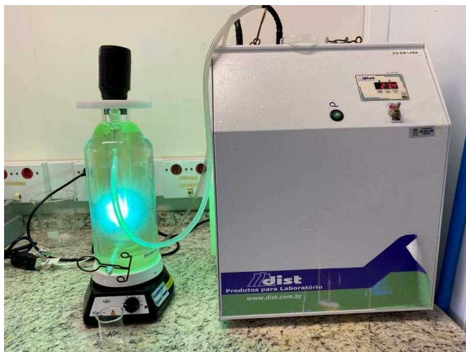
Figura 23 - Reator de degradação fotoquímica apoiado sobre agitador magnético junto ao dispositivo de refrigeração.
