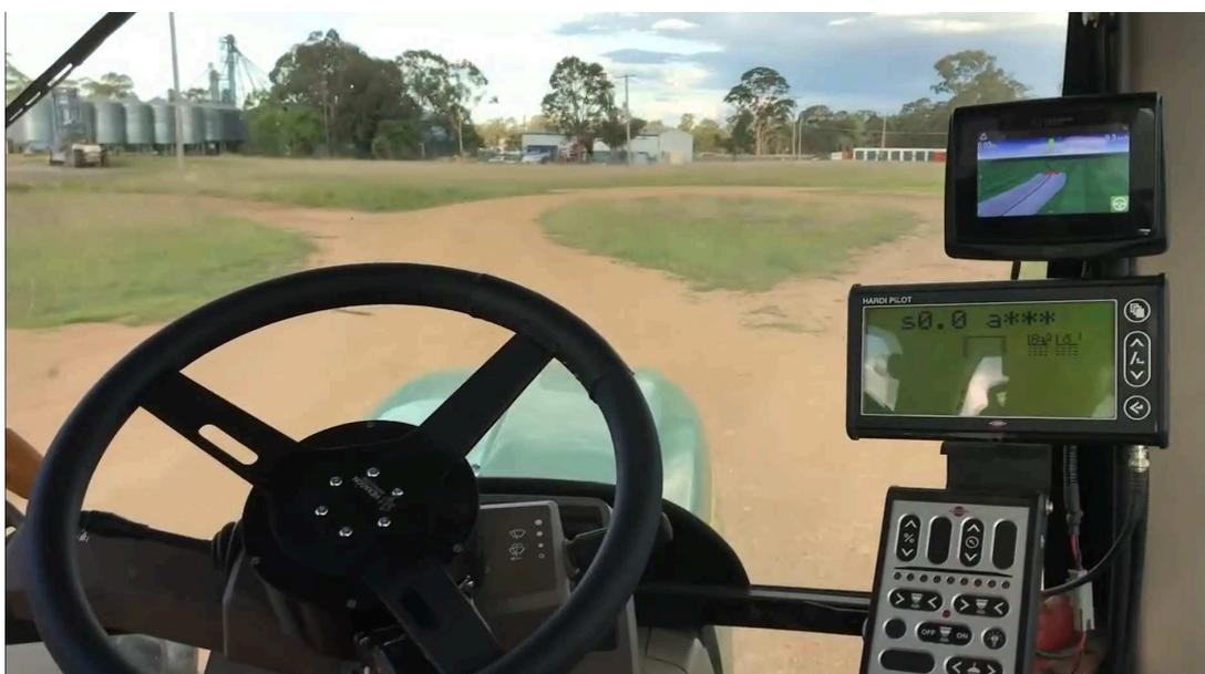
Figura 9 – Uso real do *Auto Steering* operando com o motor *Track Controller*.
