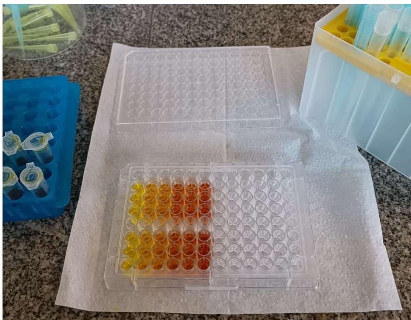
**Figura 3:** Placa microtitulação com a curva de calibração com teores de açúcares conhecidos para aferição de absorvância, podendo se calcular os teores de açúcares
