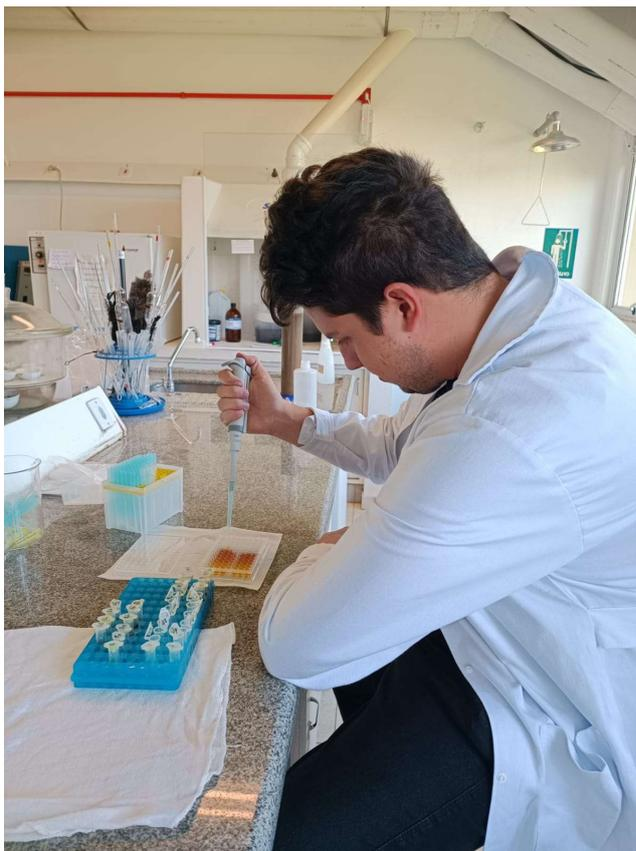
**Figura 2:** Procedimento de pipetação em placa acrílica 96 microtubulos para leitura em fotorefratometro.
