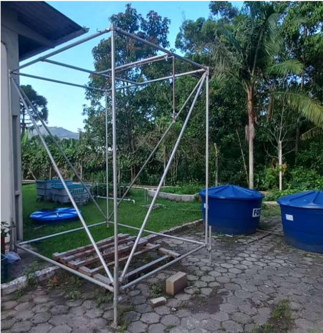
**Figura 4** Caixa de escoamento superficial do solo. Uma caixa de madeira (100 cm x 20 cm x 7,5 cm) com uma aba de 5 cm na extremidade frontal acoplada a uma calha de metal, e coberta com terra a uma profundidade de 5 cm.
