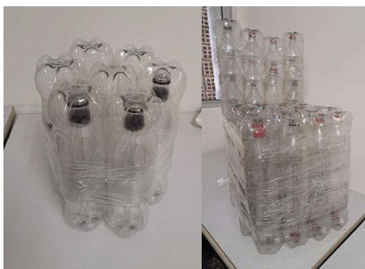
Figura 4: Protótipo de puff infantil (esquerda) e cadeira com encosto (direita). Fonte: elaborado pelos autores.
