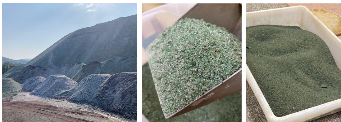
Figura 3: Coleta; Aspecto granular da escória coletada; Aspecto após a cominuição no moinho. Fonte: Autores
