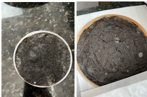
Figura 1 e 2: Resultado das produções A1 e A2 com material em recipiente plástico e de madeira, mofado com a presença de umidade e tapagem. Fonte: elaborado pelos autores.
