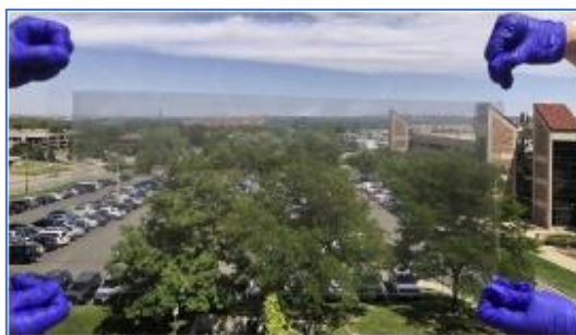
Figura 1: Película termocrômica de dióxido de vanádio. Fonte: Elaborado pelos autores [8].
