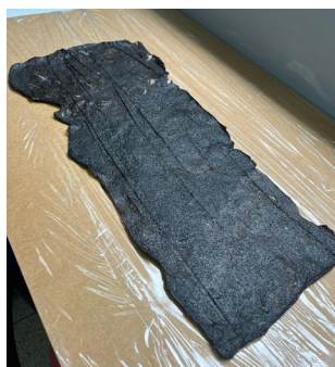
Figura 6: Resultado da produção D com material de 80x20cm seco, sem presença de mofo, textura couroina. Fonte: elaborado pelos autores.
