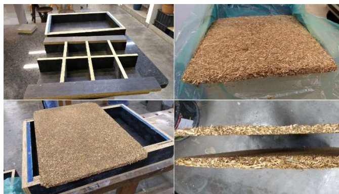
Figura 3a, 3b, 3c e 3d: a- Fôrma final; b- Chapa 1; c- Chapa 2; d- Comparação de espessura das chapas. Fonte: elaborado pelos autores.
