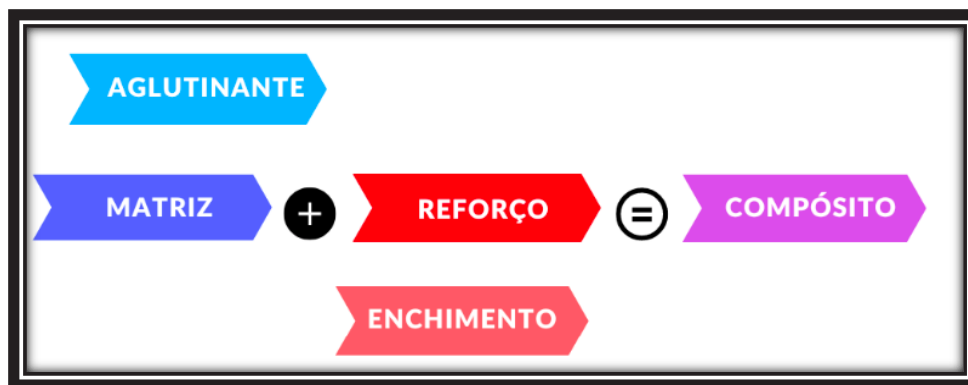
Figura 1: Fases constituintes do compósito. Fonte: https://www.ucsminhaescolha.com.br/
