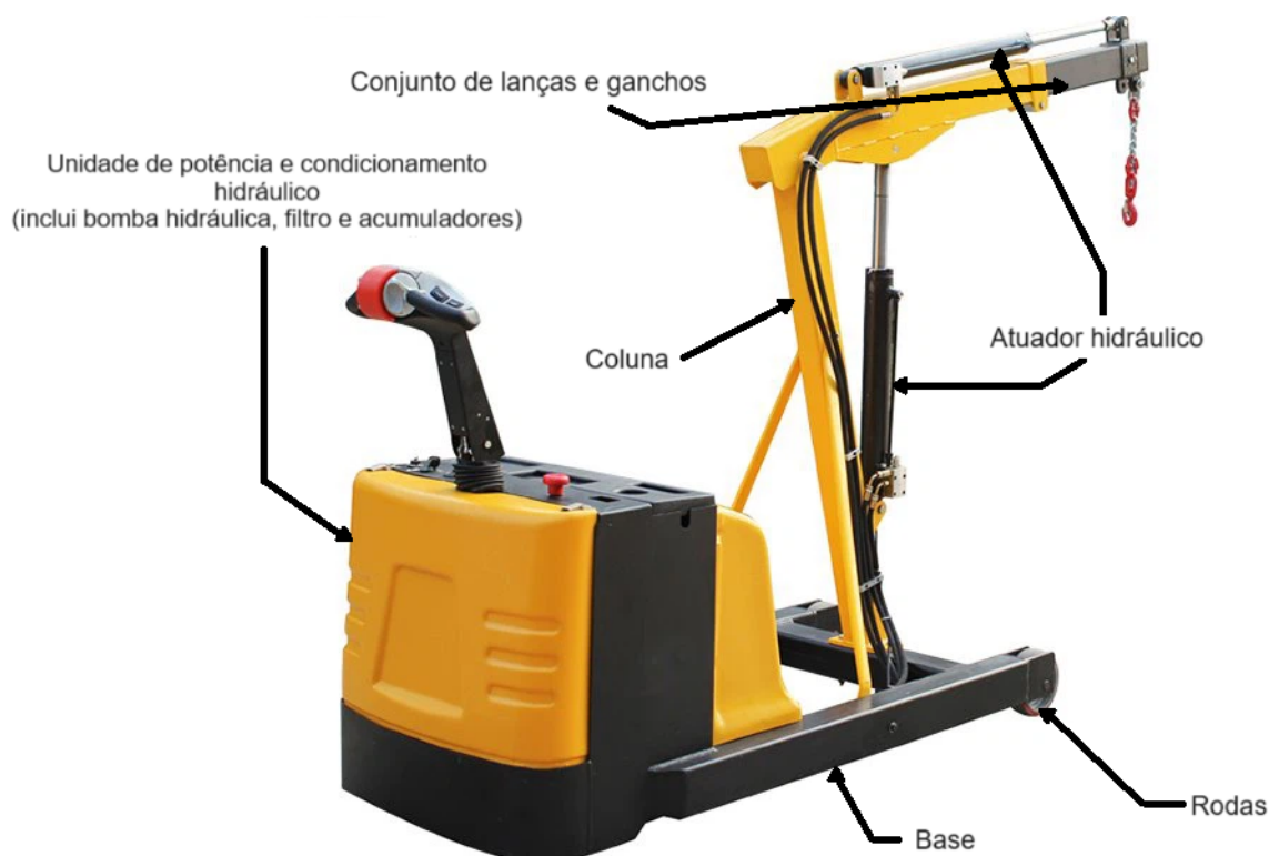
Figura 5 – Guindaste hidráulico móvel de acionamento automatizado.
