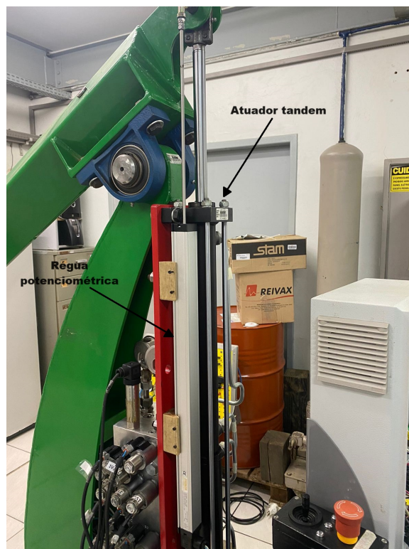
Figura 32 – Régua potenciométrica acoplada ao atuador tandem .
