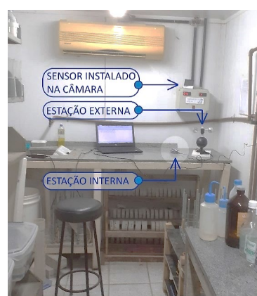
Figura 5: Câmara climatizada com localização dos sensores. Fonte: elaborado pelos autores.
