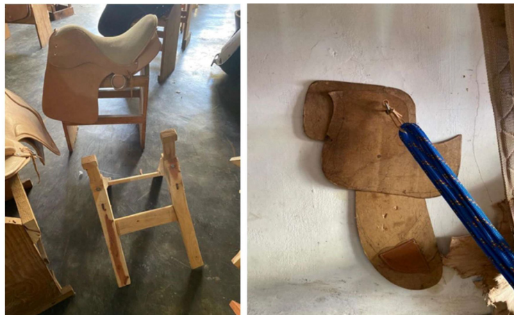
Figura 2: Cavaletes de produção(esquerda); modelo para corte de couro(direita) .Fonte: Arquivo dos autores.
