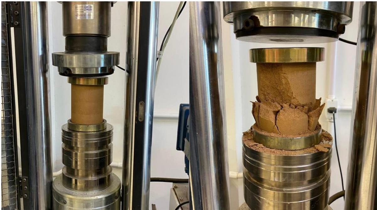
**Figura 3:** CPs elaborados para ensaio de resistência mecânica: (a) antes e (b) após o rompimento. Fonte: autores.
