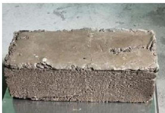
**Figura 3:** Tijolo de areia plástica após removê-lo do molde. Fonte: Chauhan *et al.*, 2019.
