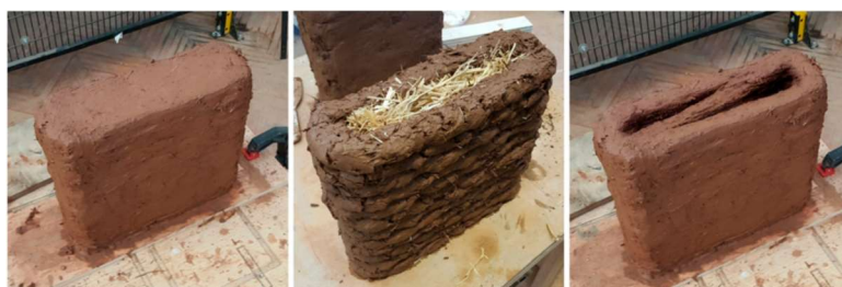
Figura 6: Protótipo sólido, com fenda simples e enchimento de palha e com fenda dupla. Fonte: [17]
