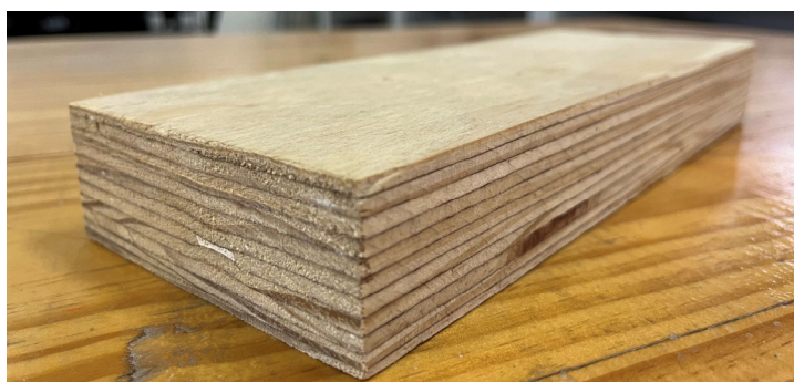
Figura 3: Chapas de LVL. Fonte: Acervo do autor (2020).
