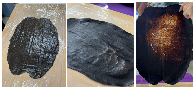
Figura 10, 11 e 12: Produção E, material com menor quantidade de óleo de coco. Fonte: elaborado pelos autores
