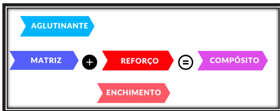
Figura 1: Fases constituintes do compósito. Fonte: https://www.ucsminhaescolha.com.br/
