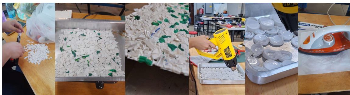
Figura 03 – Corte das tampas, derretimento, chapa obtida, teste com soprador e teste com ferro. Fonte: Autores.
