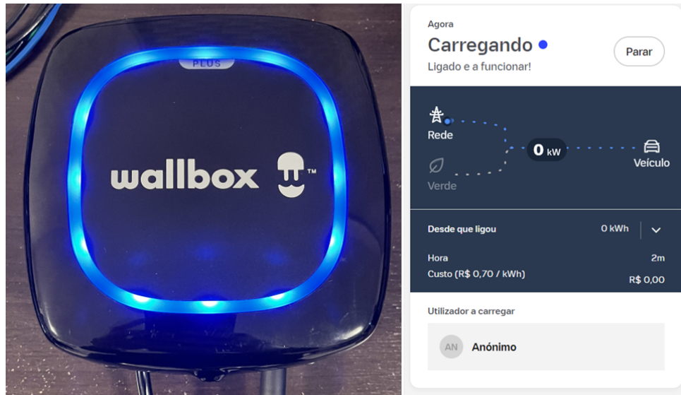
Figura 33 – Carregador no estado carregando. Fonte: Elaboração Própria.
