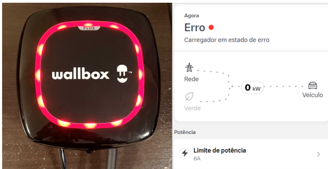
Figura 41 – Carregador em erro após curto-circuito entre CP e PE. Fonte: Elaboração Própria.
