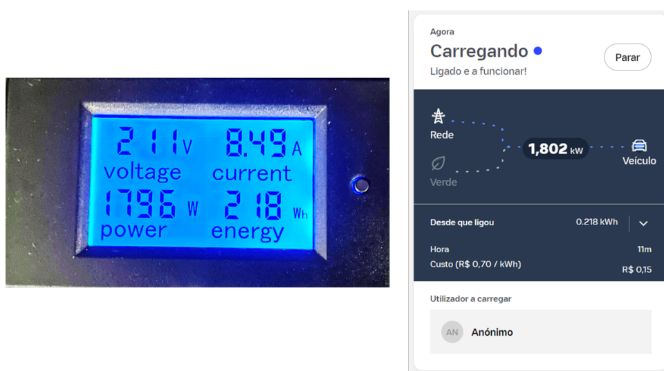
Figura 38 – Teste de transferência de energia. Fonte: Elaboração Própria.
