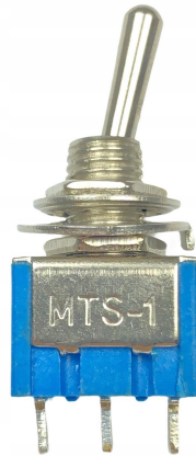
Figura 20 – Chave MTS-103. Fonte:(MTS... , 2024)
